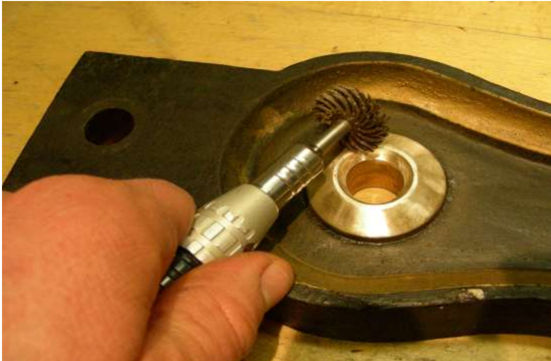
Oberflächenbearbeitung des Messinglagers
