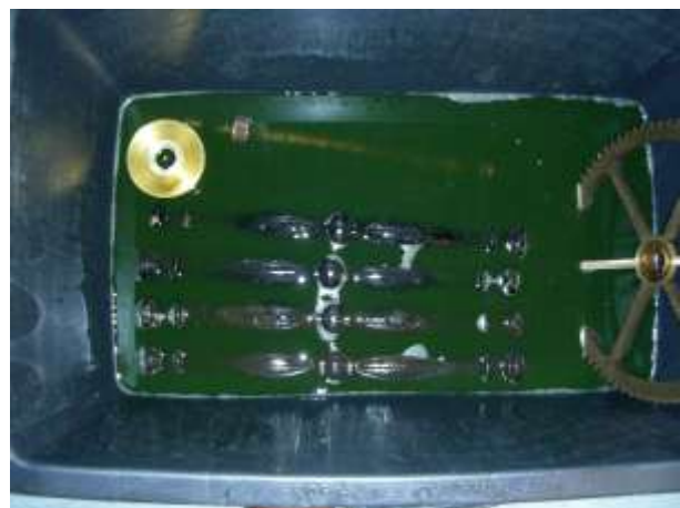
Messing und Stahlteile in Reinigungs-Lösung
