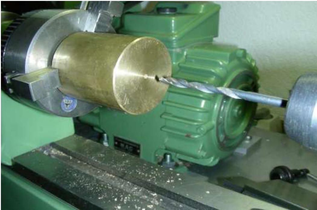
Rundmetall in Dreibackenfutter eingespannt- Loch wird mit Bohrer gebohrt
