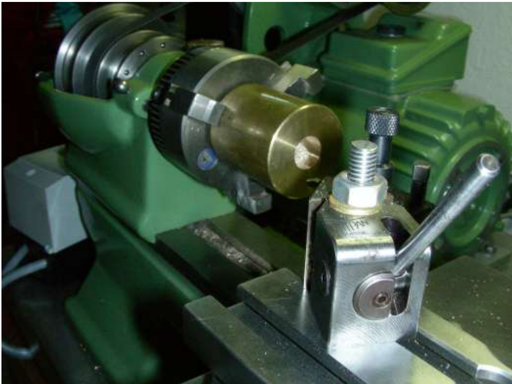
Bohrung wird mit Hilfe eines Innen-Ausdreh-Stichels abgetragen
