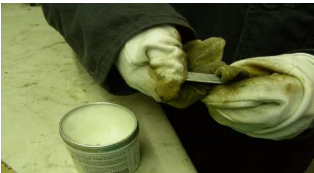
Einreiben mit Mikrokristallinem Wachs
